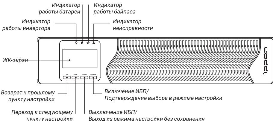
\* Одновременное нажатие и удерживание кнопок UP+DOWN в течение 3 секунд – переход в меню настроек
