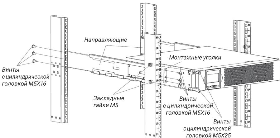
2. Выберите подходящий размер стойки для установки ИБП. Направляющая имеет четыре положения на передней и задней стенках стойки.
