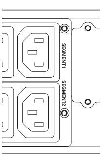
Сегмент 1: При работе от батарей можно настроить отключение сегмента 1 в первую очередь, когда батареи будут разряжены до уровня EOD. Значение EOD можно настроить с помощью ЖК-дисплея (см. раздел 6.2.5. Настройка функций). Служит для отключения менее приоритетной нагрузки с целью экономии заряда батарей для питания более приоритетной нагрузки.
