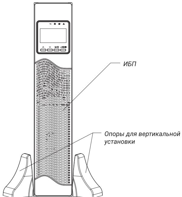
4. Разница в том, что опоры для вертикальной установки собраны с использованием удлинителя опоры:
