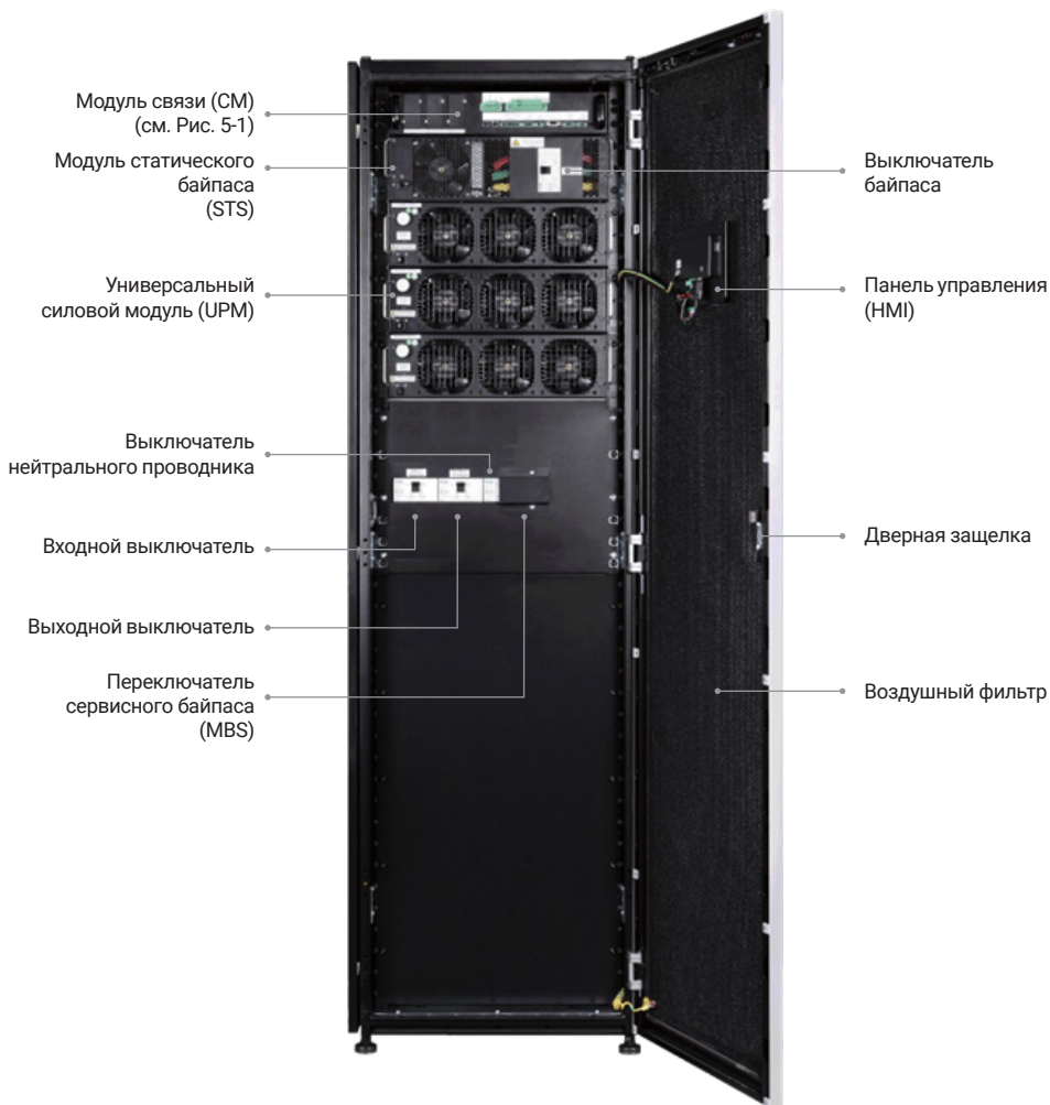
Рис. 2-2. Расположение компонентов (шкаф Innova Modular Cabinet 75K без внутренних АКБ)
