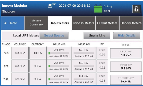
Рис. 6-7. Экран Input Meters с подробными показаниями
