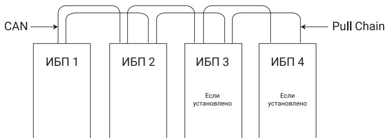
Рис. 4-12. Упрощенная схема подключения CAN и Pull-Chain в системе параллельных ИБП
