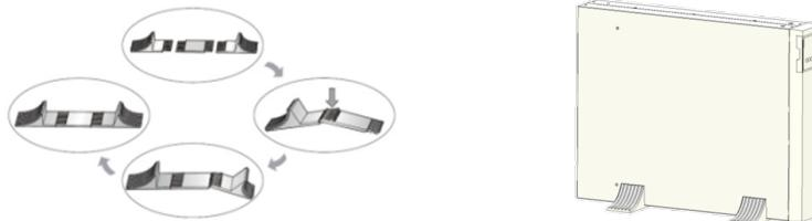
При сборке используйте расширительную пластину, входящую в комплект поставки батарейного модуля.
