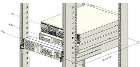
Выносной блок PDU предоставляет более удобный доступ к выходным разъемам ИБП, а также оборудован дополнительными выходными розетками, входным автоматом и сервисным переключателем байпаса.
