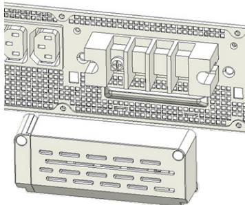
2. Подключите заземляющий проводник входного и выходного кабелей к соответствующим клеммам ИБП.
