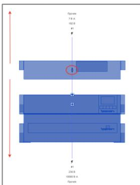
Также можно собирать сборки с дополнительными батарейными модулями через отключение частей подставки:
