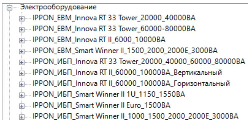
Также можно воспользоваться лентой. Перейдите на вкладку «Системы», нажмите по команде «Электрооборудование» - «Электрооборудование». В окне свойств нужно выбрать подходящий типоразмер и разместить его в пространстве модели.
