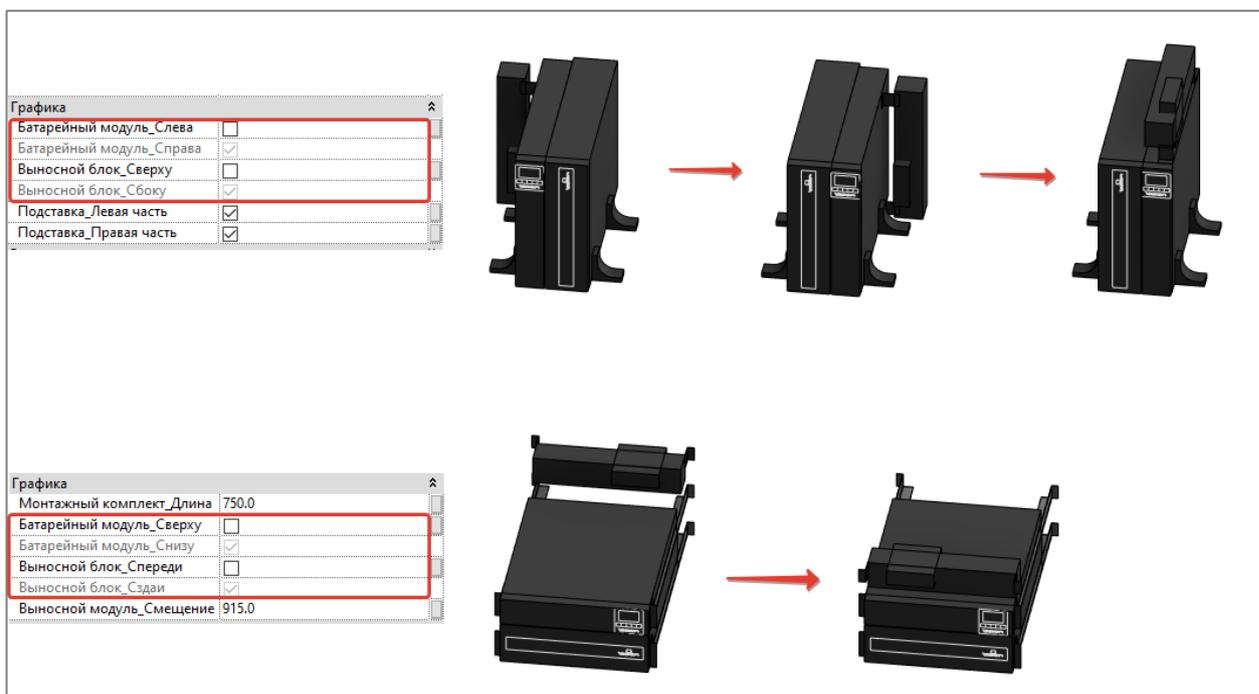
Выносной блок можно смещать по высоте в шкафу с помощью «ручки» или через параметр «Смещение» в свойствах по экземпляру:
